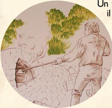
Un four de verrier était fait de briques à cupules. Semi-enterré, il avait des trous sur les côtés pour faciliter l'assemblage de la matière. La base du four avait une forme parallépipédique trapézoïdale et la partie supérieure bombée. On fabriquait ici du verre de fougère. (voir gazette n°5).
